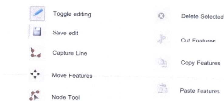
๒. เริ่มทำการนำเข้าข้อมูล (Digitize) โดยคลิกที่ปุ่ม Capture Line และใช้เมาส์ทำการ Digitize ไปตามเส้นถนน ทางรถไฟ แม่น้ำ หรือลักษณะที่เป็นแบบเส้น จากนั้นก็ใส่ข้อมูล Attribute ใน ช่องว่าง และคลิกปุ่ม OK
